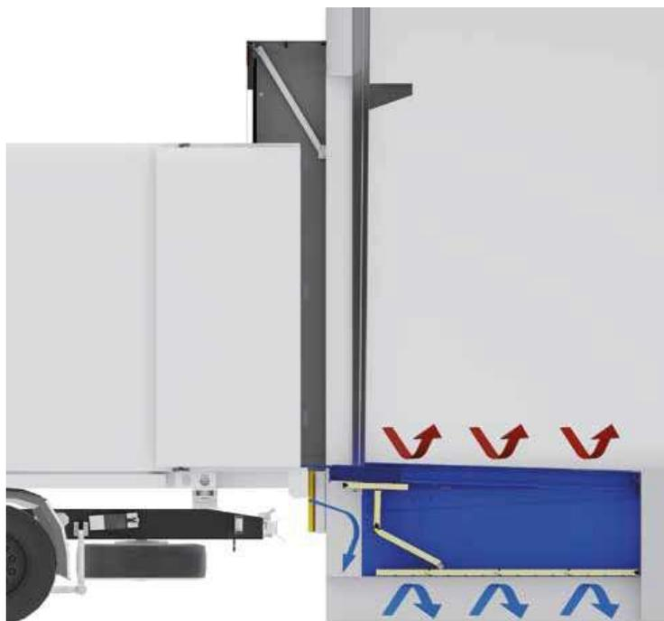
Sección transversal del muelle de carga ISO
