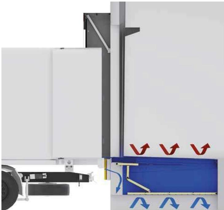
Sección transversal del muelle de carga ISO
